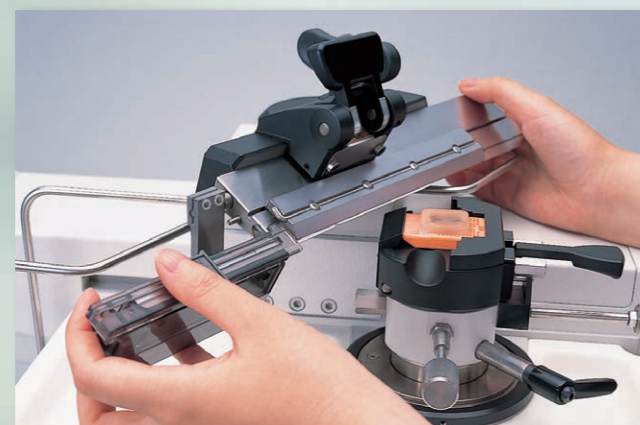
替刃交換時、刃のずれを防ぐ替刃ホルダー
